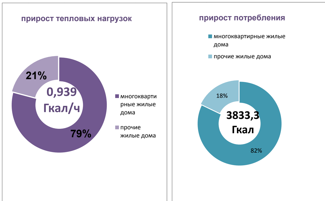
Рис. 2.7. Распределение общего прироста перспективных тепловых нагрузок и годового объема потребления тепловой энергии для жилищного фонда по видам зданий
